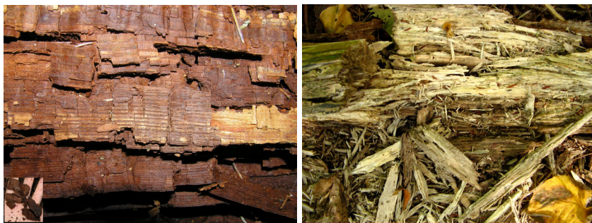
Obr. 3.5: Hnědá a bílá hniloba dřeva. Typy hniloby se liší chemicky podle toho, které molekuly je schopná daná houba zpracovávat a které zůstávají. U hnědé hniloby zůstává primárně lignin, u bílé primárně celulóza.
